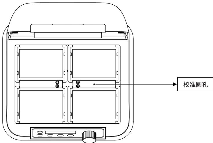
2. 系统菜单中短按光标移动键，跳转到Calibration，使能校准模式后长按Start/Stop进入校准模式，仪器自动升温至40.0°C。
