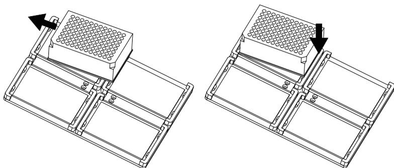
如上图所示，将微孔板卡入加热平台中，安装完后建议垂直轻轻按压微孔板表面，确保微孔板与加热平台之间安装平整且无松动。
